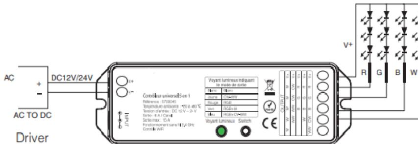
Connexion du contrôleur au ruban LED RGB+W
