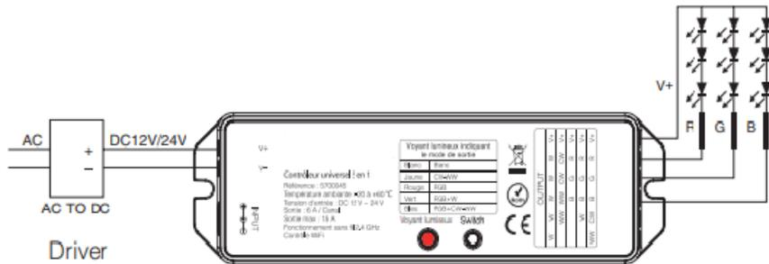
Connexion du contrôleur au ruban LED RGB
