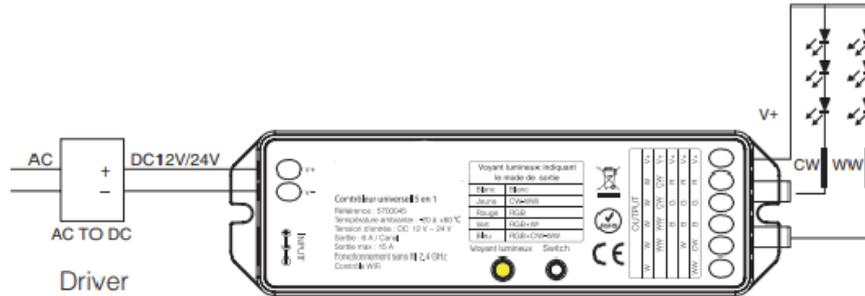
Connexion du contrôleur au ruban LED CW-WW
